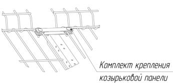
К Г-образным штангам барьера безопасности крепятся козырьковые сетчатые панели при помощи комплектов крепежа с метизами, по 2 крепления на каждую штангу.
