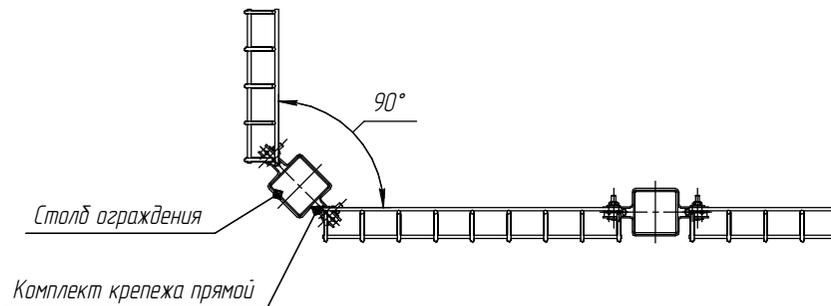
Поворот ограждения на угол 90° и более с использованием кронштейна концевой
