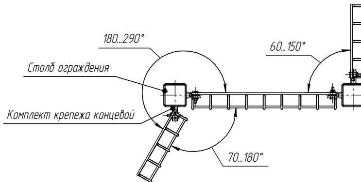
Поворот ограждения на угол более 90° с использованием кронштейна прямого
